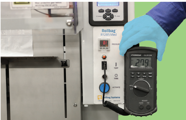
Monitoring temperature on a R1285 Med Automatic Bagger.
