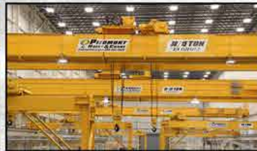
30 & 60 Ton Bridge Cranes
